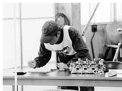
課題2に臨む他県の選手 バルブクリアランスとシムを測定し、基準値になるように適切なシムを選択するという高度な問題
