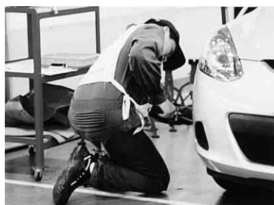
ボルト、ナットの締め付けは、当然トルクレンチを使用
